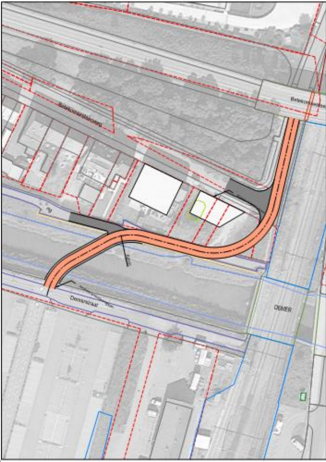
cn Figuur 3-31: Demerkruising concept 6 – schuine brug
