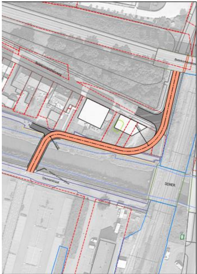
Figuur 3-30: Demerkruising concept 5 – gebogen brug
