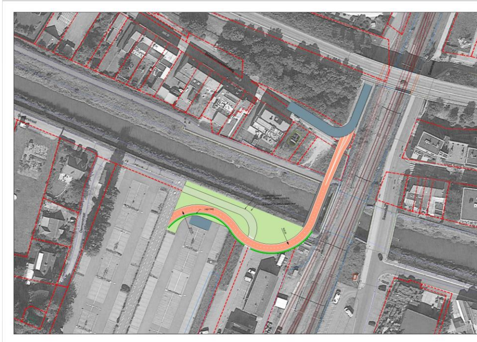
Figuur 3-28: Demerkruising concept 3 – rechte brug, compromis bochtstralen – innames
