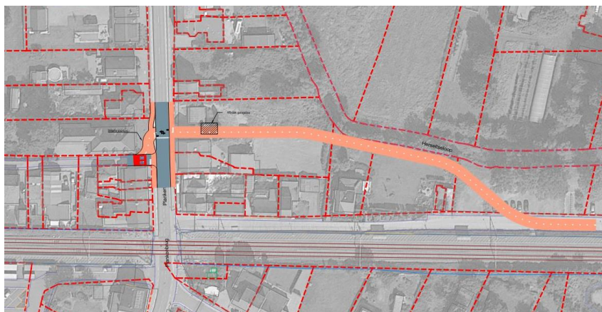
Figuur 3-9: Principeschets concept 3bis – nieuwe fietsverbinding, gebundelde fietsoversteek
