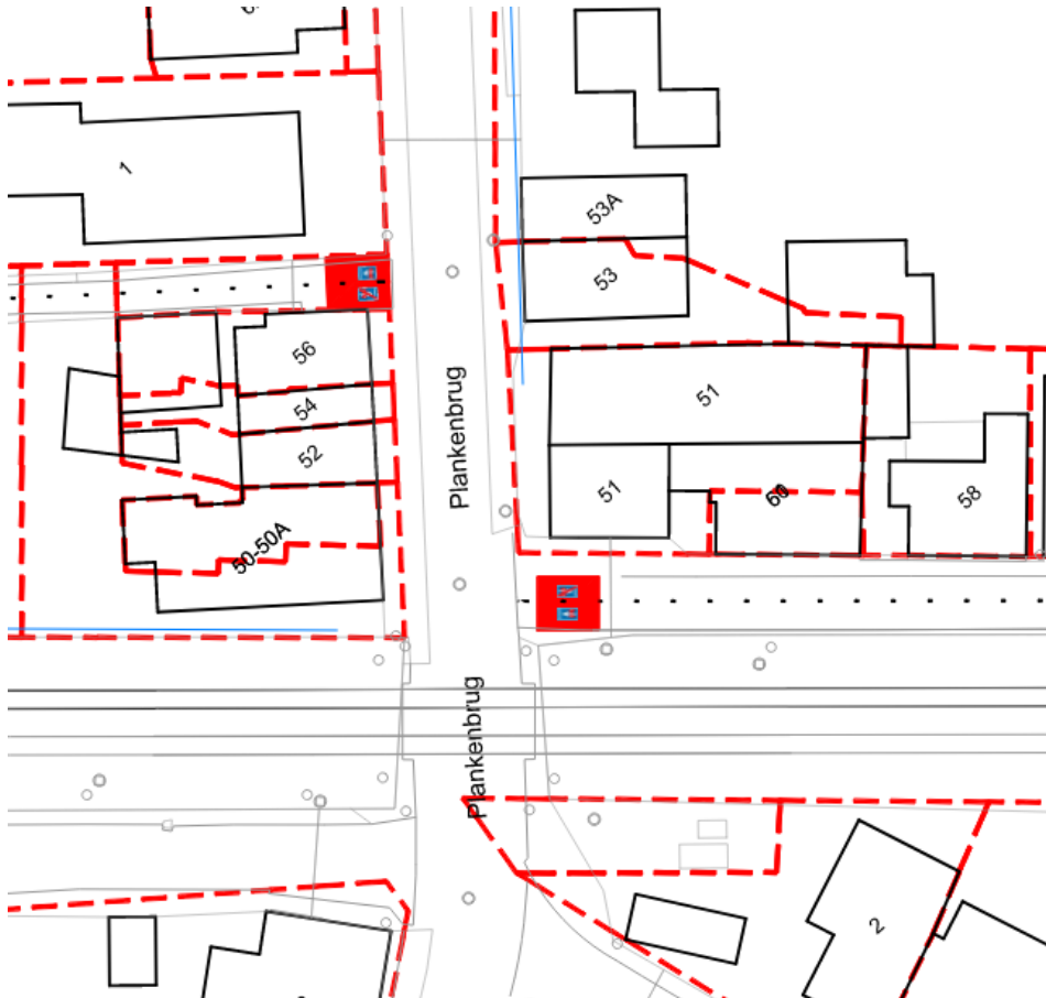
Figuur 3-6: Principeschematische concept 1 – behoud infrastructuur, geen aangeduide fietsoversteken
