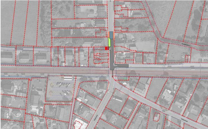
Figuur 3-7: Principeschets concept 2 – gemengd verkeer
